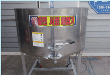
사료 배합기 fodder mixer 사료 배합기에 사료를 투입합니다. Add feed to a fodder mixer.
