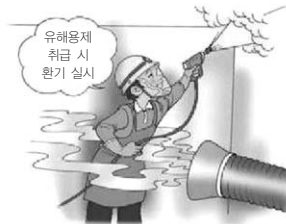
유기용제 취급 시 환기 실시 (yugiyongje chwigeup si hwangi silsi) Letting some fresh air in when using organic solvents
